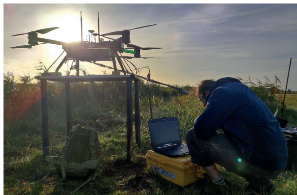
Zum Aufspüren von tiefen Grundwasserschichten setzt das Projekt SeeKaquA ein neues drohnengestütztes Messsystem ein.
